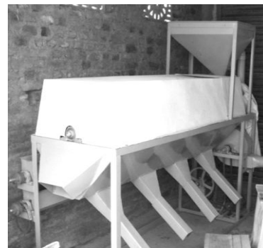
P 1.1. Installation of PKV mini dal mill PKV cleaner/grader cum polisher
